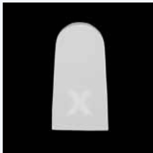
Fig. 5 : Échantillon insuffisamment cuit
